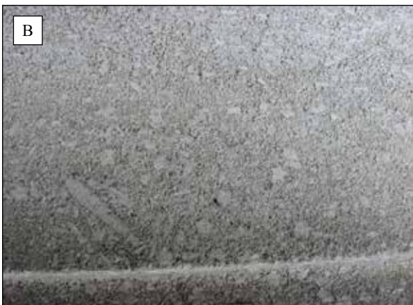
Figuur 2. A. Balusters, pilaster en sokkel in Pouillenay met zilvergrijs patina op een plint in Belgische Blauwe Hardsteen. Tiensevest 34, Wederopbouw architectuur post Wereldoorlog I. B. Pouillenay, Franse steen met Pentacrinus, vijfhoekige doorsneden van crinoiden. Tiensevest 34.
