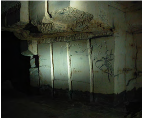
Figuur 13. Maastrichtersteen: groeve Lacroixberg te Zussen. Gang met posterieure ontginningsfronten onder oudere ontginningszijwanden. Merk de horizontale sporen tegen het plafond veroorzaakt door de hak waarmee de te ontginnen blokken of sjtolen oorspronkelijk werden losgemaakt van het plafond (Foto F. Doperé)
