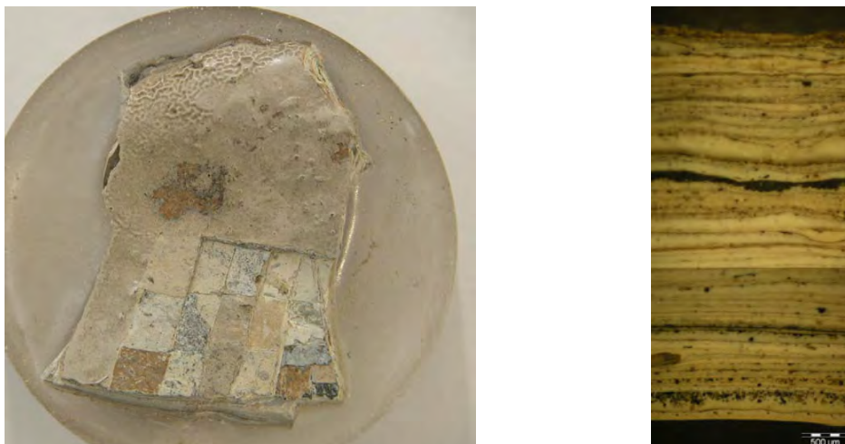
Figuur 30. Microscopische opname van doorsnede van het verfpakket; links: stratigrafie op verflagenpakket; rechts: doorsnede van verflagenpakket. Madonna Paradijsstraat Antwerpen. Foto Studio Steen, Antwerpen.
