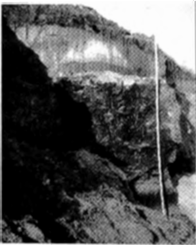
Foto 5 - Veenmuurtje met erop de intact gebleven, koepelvormig begrensde sedimenten van de afzetting van Duinkerke. De lat meet 3 m (Noordelijk Insteekdok, foto auteur)
