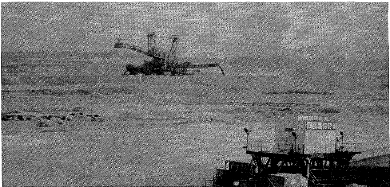
Fig. 30 - Eén van de gigantische baggermachines, waarmee de bruinkool gewonnen wordt (hier bij Bedburg ten noorden van Paffendorf). Op de achtergrond een van de vele electriciteitscentrales in dit gebied die geheel op bruinkool draaien.
