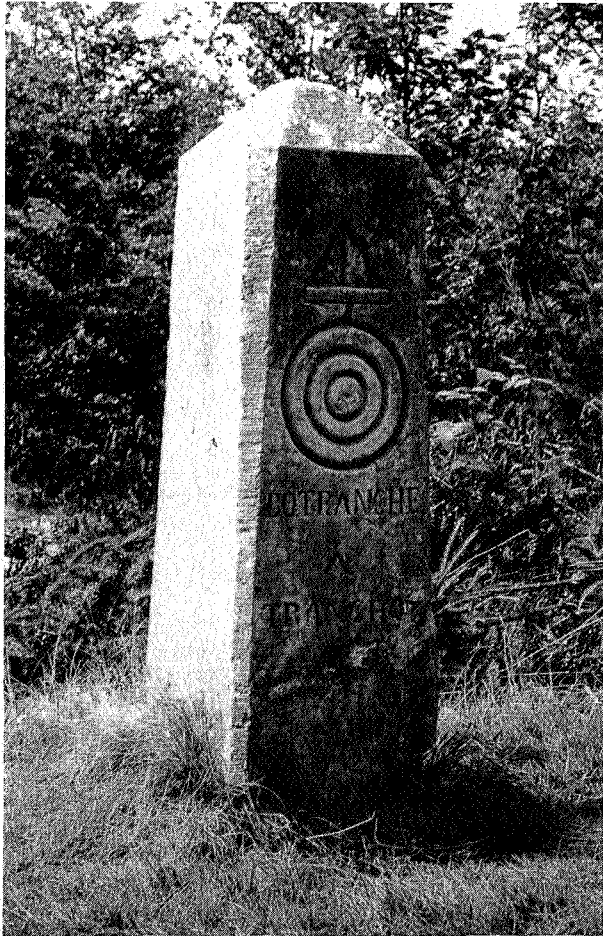
Fig. 116 - Het hoogste punt van de Euregio Maas-Rijn (694 m) wordt gemarkeerd door de zuil van Tranchot bij Botrange; Deze 80 cm hoge zuil vormde een van de drie trigonometrische punten van de eerste orde (samen met soortgelijke punten op de Lousberg bij Aken en de "Schwarzer Mann" in de Schnee-Eifel), waarop Joseph Tranchot zijn kaart van dit gebied baseerde, waarvoor hij tussen 1803 en 1807 metingen verrichtte.
