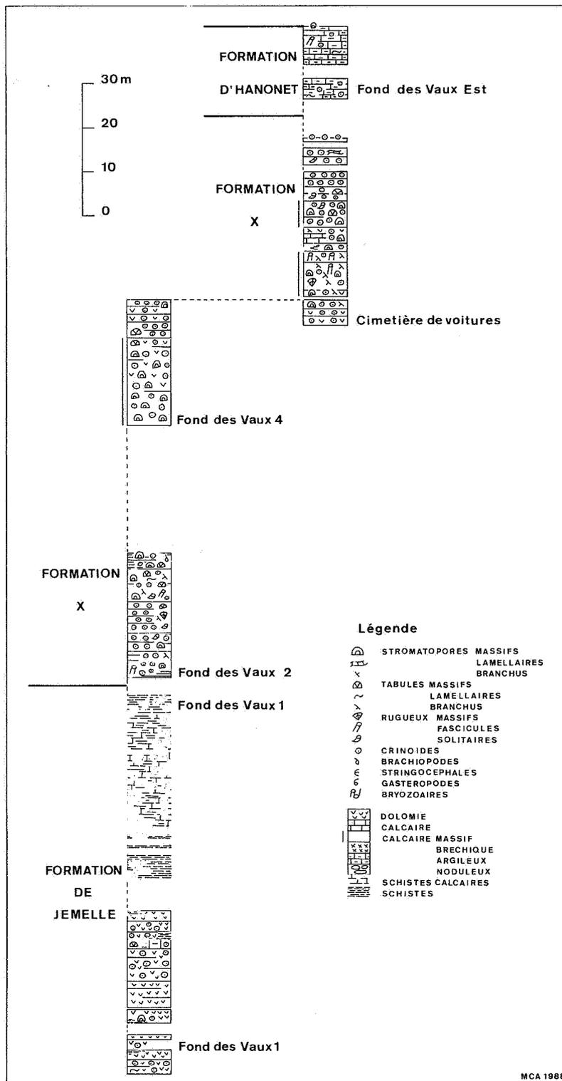
Figure 2 - Colonne lithologique du Couvinien du Fond des Vaux.
