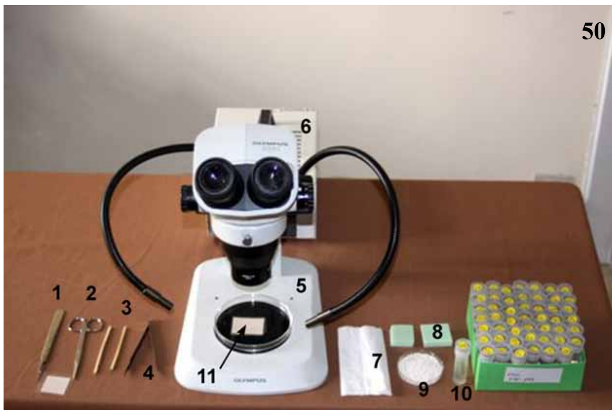
Fig. 50 . Materiaal bij het determineren: 1. scalpel. 2. schaar. 3. priemen. 4. pincet. 5. stereomicroscoop. 6. koude lichtbron. 7. lenspapier. 8. steekblokjes. 9. petrischaaltje met glaspareltjes. 10. verzamelbuisje. 11. millimeterpapier.
