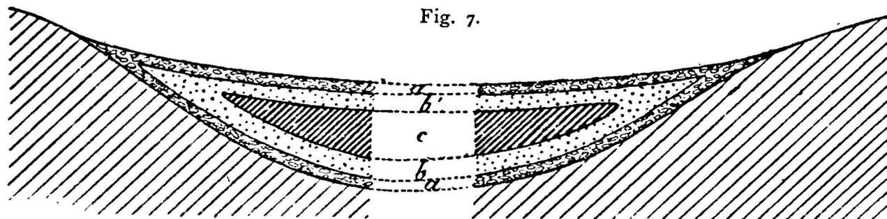
*aa'* Enveloppe extérieure de gravier composée, en bas, du *gravier d'immersion* (*a*), et en haut, du *gravier d'émersion* (*a'*).
