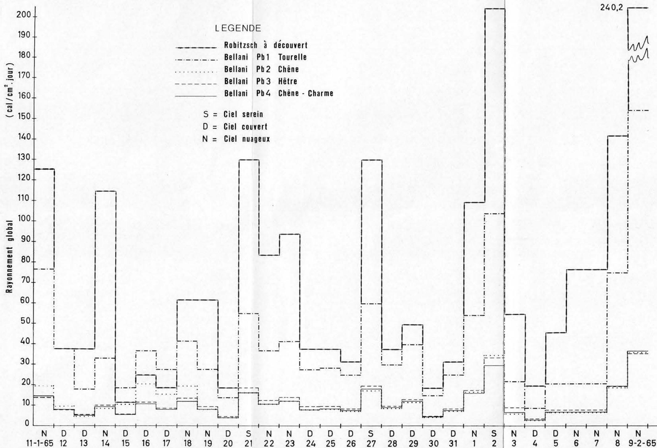
Fig. 2. — Variation du rayonnement global incident reçu à découvert (surface horizontale et surface sphérique) et du rayonnement global reçu sous différentes variantes de couvert forestier (surface sphérique) (du 11-I-1965 au 9-II-1965).
