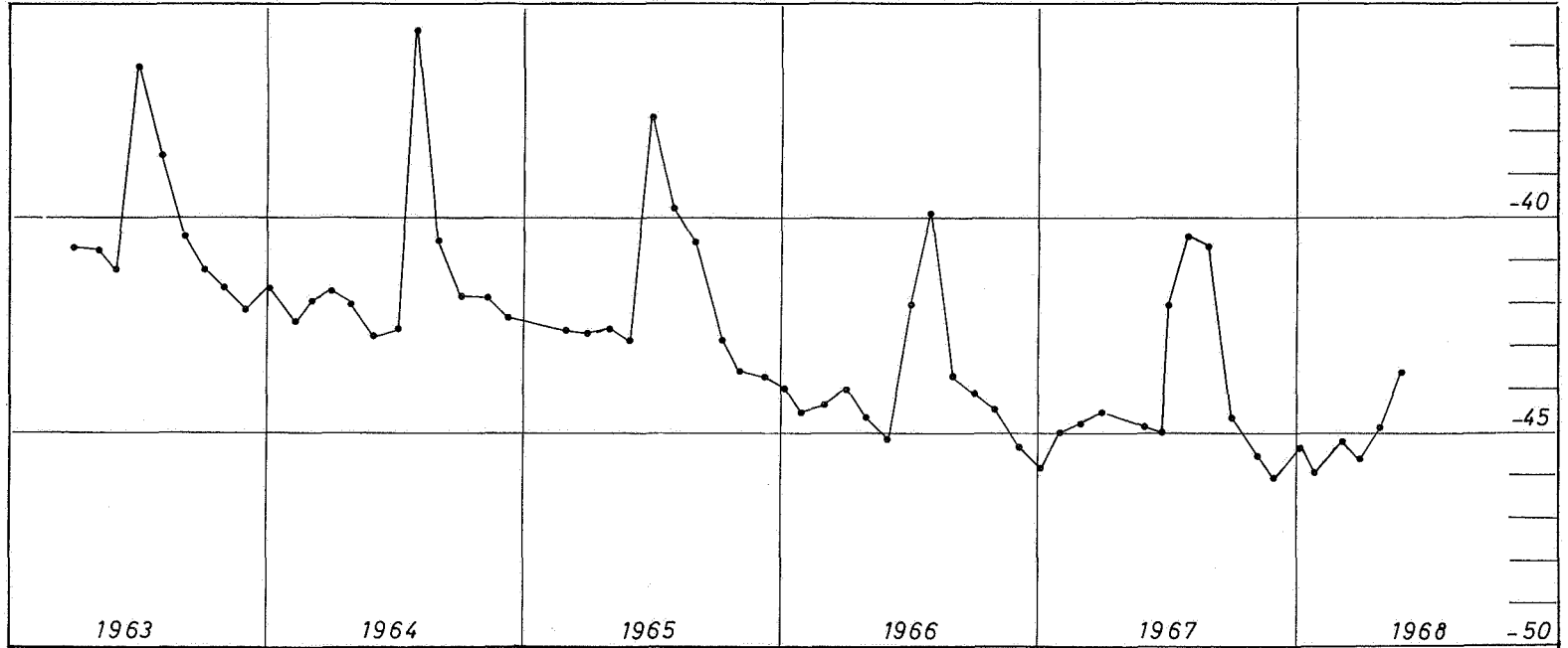
Fig. 5: Variations piézométriques de la nappe du calcaire carbonifère dans le forage de bondues.
