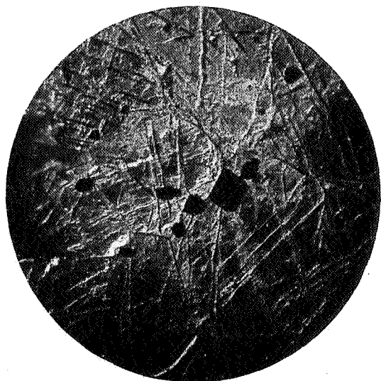
FIG. 2. — Sections de chromite en enstatite ( \times 40 ).
