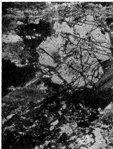
PHOTO 4. — Cristal de grenat dans un mica-schiste à biotite, muscovite et staurodite ( \times 22 ).
