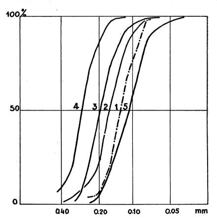
Fig. 3. — Courbes granulométriques de sables tongriens. (Fréquences pondérales calculées d'après des mesures au microscope.)
