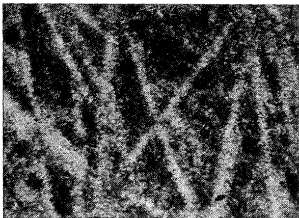
FIG. 7. — Autoradiographie d'une section polie taillée dans le même morceau de bétafite fondue au four solaire et montrant la concentration de la radioactivité dans les constituants translucides. Le constituant opaque n'est pratiquement pas radioactif. (Gross. 60.)
