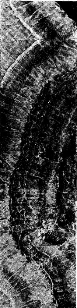
FIG. 1. — Concrétions de calcite fibroradiée et rubanée traversée par le sondage de Wépion à 997 m. Le diamètre de la carotte est de 13 cm.
