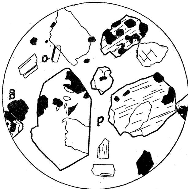
FIG. 2. — Partie du résidu de la roche C. S. K. 2, de densité inférieure à 3,33 ( $\times 150$ ).
