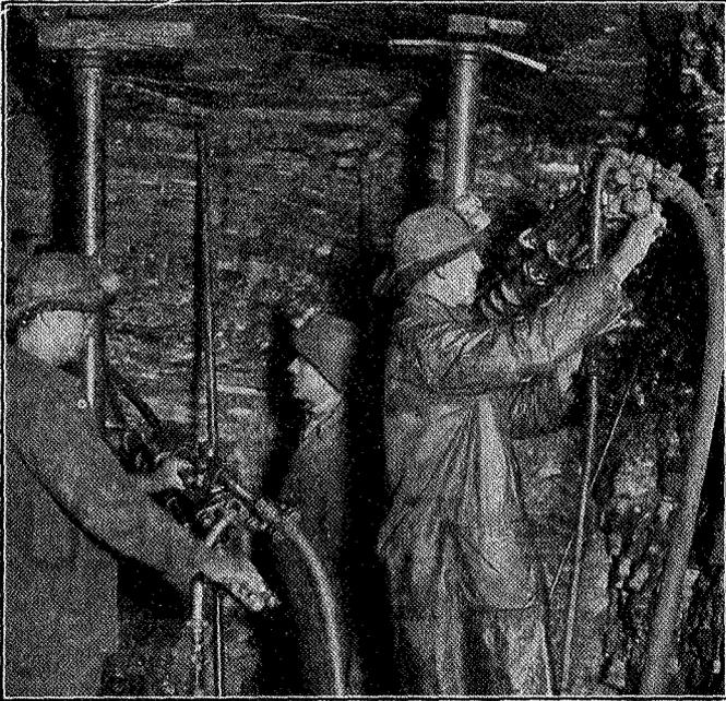
Le Tuyau à Air comprimé
