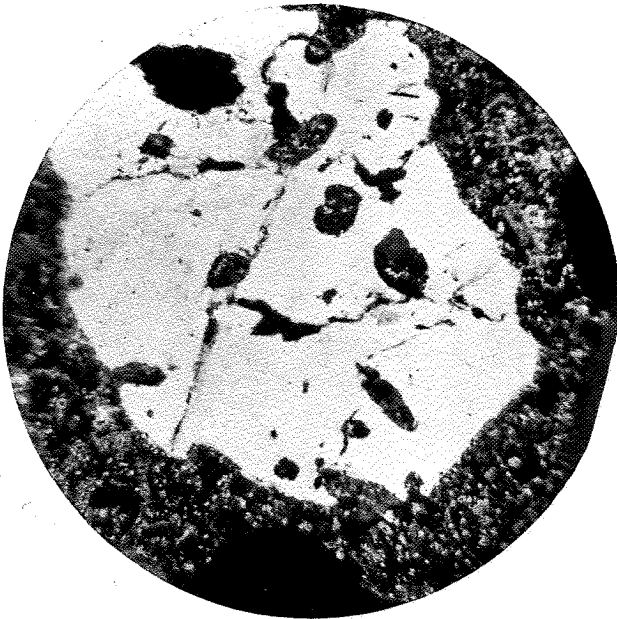
QUARTZ DE LA MICRODIORITE QUARTZIFÈRE DE QUENAST AVEC INCLUSIONS DE LA PATE. (Nicols croisés \times 36 .)
