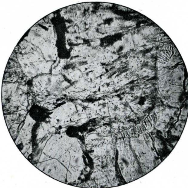
FIG. 2. — MÊME ROCHE MONTRANT LES INCLUSIONS ET LEUR RELATION AVEC LES SUTURES DES GRAINS DE QUARTZ ET DE FELDSPATH.
