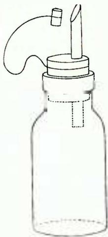
FIG. 229. — Flacon à tubulure.
