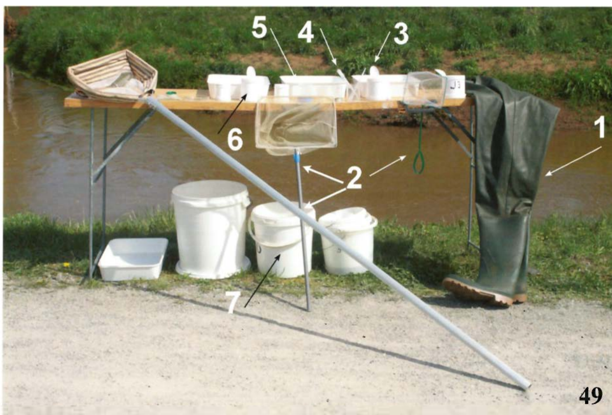
Fig. 49. Materiaal bij het bemonsteren: 1. waadpak of laarzen. 2. kleine en grote netten. 3. lepels. 4. knijppipet. 5. witte bak. 6. potjes. 7. afsluitbare emmer.
