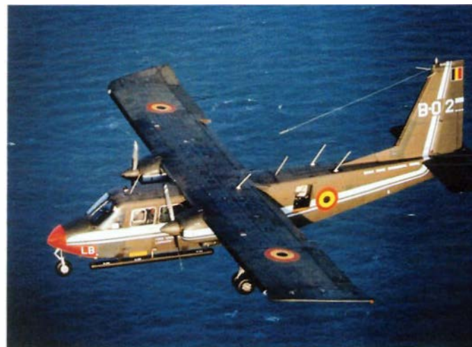
DES AVIONS DOTÉS D'INSTRUMENTS DE TÉLÉDETECTION (RADAR, SENSEURS INFRAROUGE ET ULTRAVIOLET,...) SONT CHARGÉS DE SURVEILLER LES POLLUTIONS CAUSÉES PAR LE TRAFIC MARITIME, DE JOUR COMME DE NUIT.
