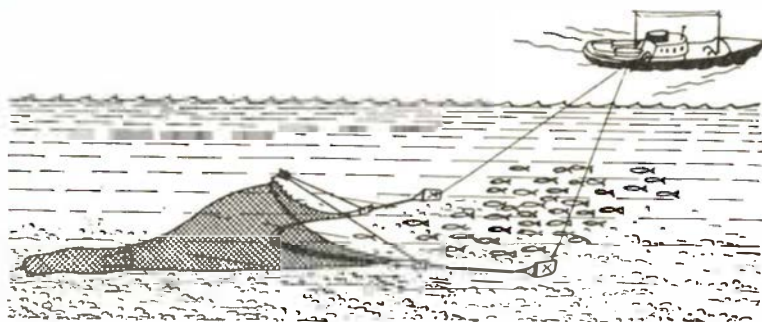
Voici comment travaille un chalut de fond. Les panneaux, se trouvant devant le chalut, le maintiennent ouvert.
