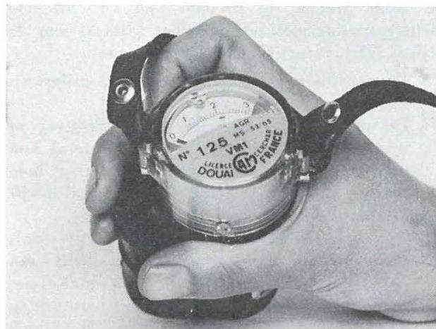
Bovendien zal de miniaturisering van de draagbare mijngasmeters ertoe leiden alle leden van de bewaking van dergelijke toestellen te voorzien, hetgeen van aard is om de veiligheid nog aanzienlijk te verhogen (fig. 28). Elk personeelslid zal zonder moeizijkheid snel en gemakkelijk op alle punten van de werkplaatsen die hem verdacht lijken, het metaangehalte kunnen controleren.
