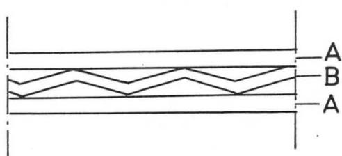
Chaque élément est constitué de trois grilles E serrées avec des intercalaires dans une cage cylindrique. Une vis centrale assure l'assemblage. Le dispositif ainsi réalisé s'introduit dans la tuyauterie.
