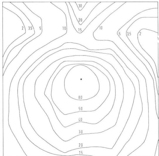
Diagramme du champ électromagnétique dans une section transversale du tunnel de Lanaye : portion centrale autour d'un câble monofilaire excité à 27 MHz (fréquence du Téléchar). La répartition du champ est presque symétrique par rapport à un axe vertical ; elle est totalement dissymétrique par rapport à un axe horizontal : on peut y voir les effets associés : 1) du câble guide d'ondes ; 2) de la forme de la galerie.
