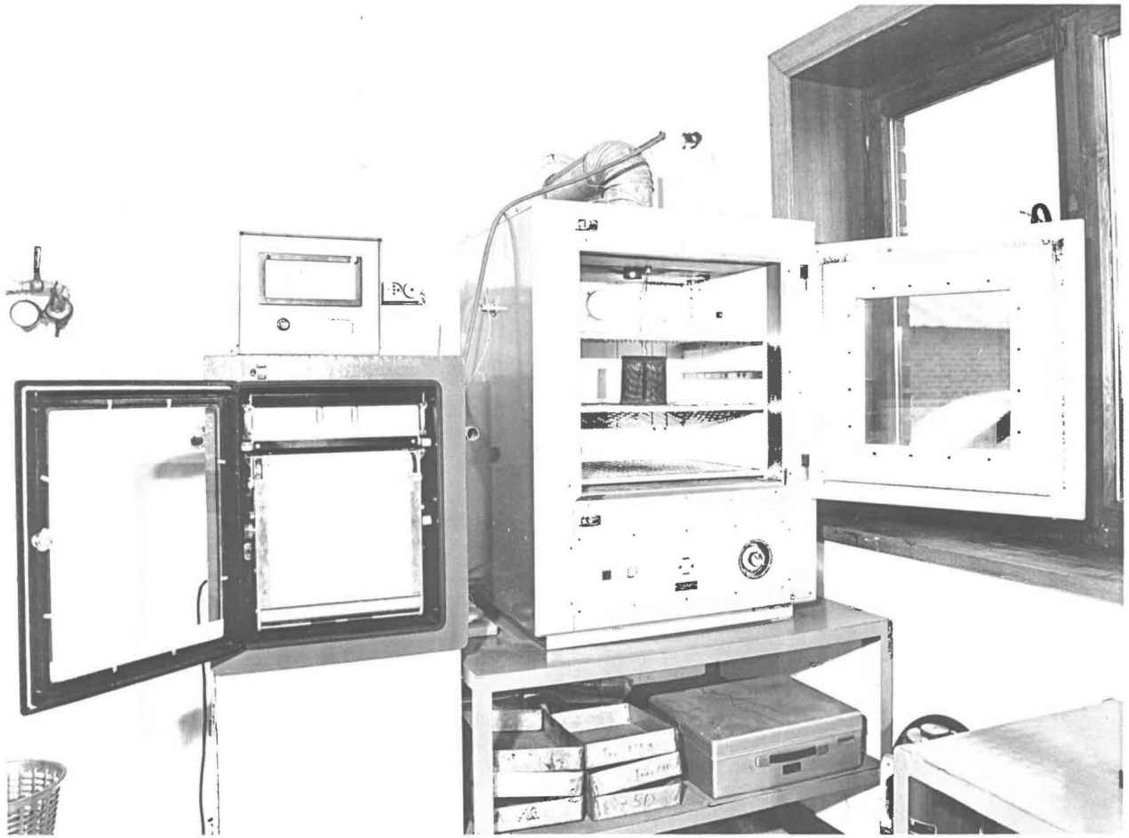
Fig. 3. Test de stockage à chaud
