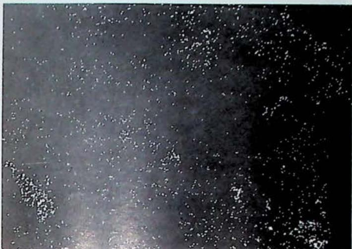
Fig. 11 : Fraction magnétique, grossissement 1.000 x. Sites d'émission de la raie  $Mg K_{\alpha}$
