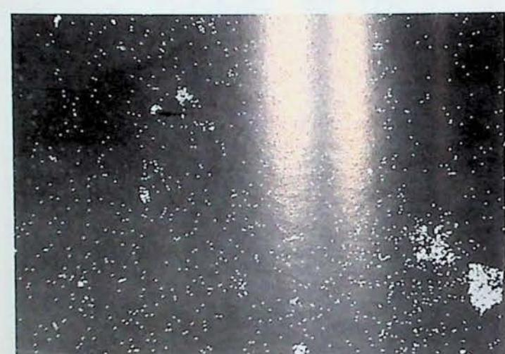
Fig. 27 : Résidu de flottation, grossissement 200 x. Sites d'émission de la raie Ti K<sub>a</sub>
