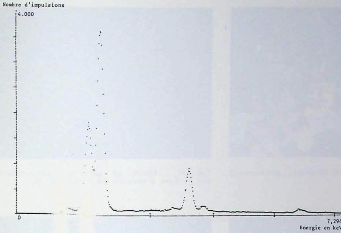
Fig. 19 : Spectre de l'émission X d'un grain de gangue. Les raies importantes sont celles de l'aluminium, du silicium et du calcium. Les raies du magnésium et du fer sont peu marquées
