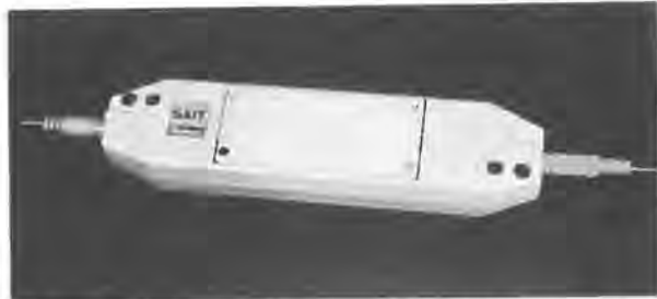
Fig. 3 : Dispositif rayonnant définitif utilisé sous cette forme dans les galeries
