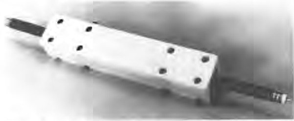
Fig. 2 : Prototypage du dispositif rayonnant en Ertalon inséré dans une ligne coaxiale
