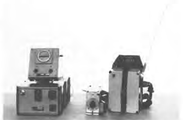
Fig. 7 : Télécommande comprenant l'émetteur qui se porte sur le dos, avec le boîtier de commande, le récepteur, le chargeur se trouvant au-dessus du récepteur
