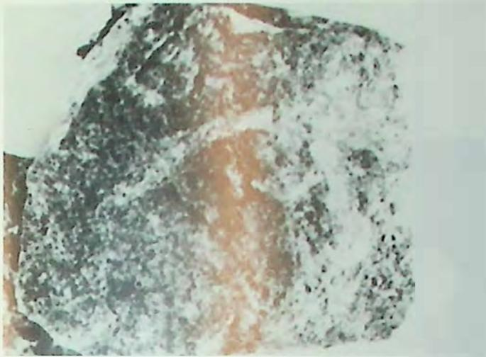
Fig. 1 : Morceau d'échantillon du minerai du gisement primaire. Minéralisation diffuse dans une gangue quartzo-carbonatée au contact de serpentine fines
