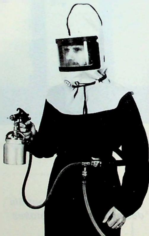
Fig. 23 : Cagoule Sundstrom à adduction d'air comprimé.
