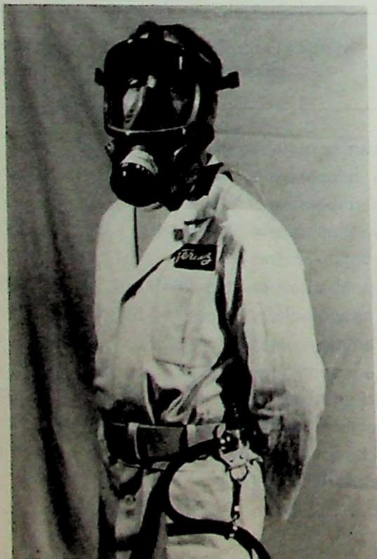
Fig 21 Couvre-face Fernez 212 à adduction d'air comprimé avec surpression.
