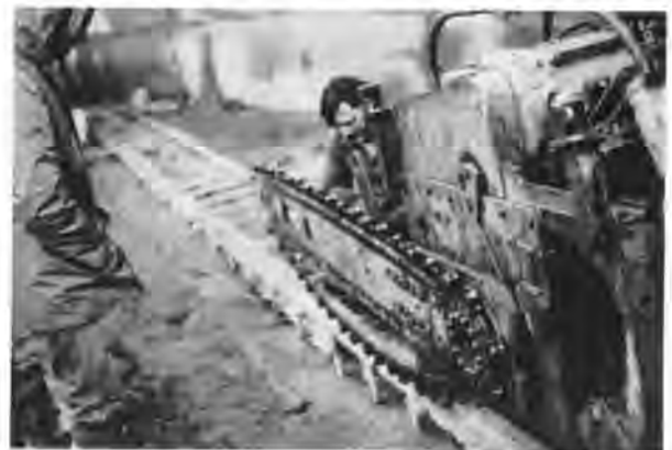
Fig. 16 et 17 — Premiers essais en carrières de la chaîne à molettes expérimentale Eerste proefnemingen in groeven met de experimentele ketting met kabelschijven
