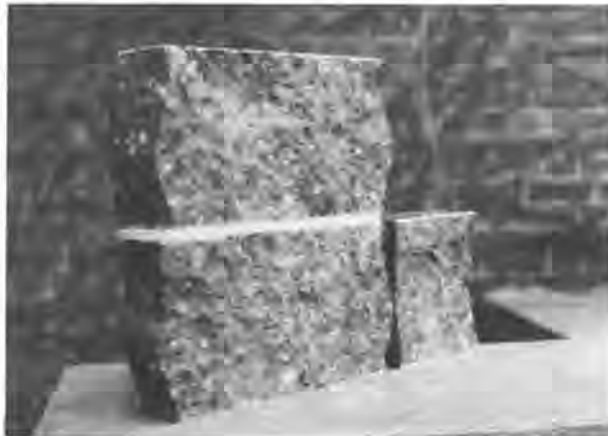
Fig. 1 — Blocs clivés en béton de résine; les charges minérales sont des concassés provenant de carrières de la région Ourthe-Amblève
