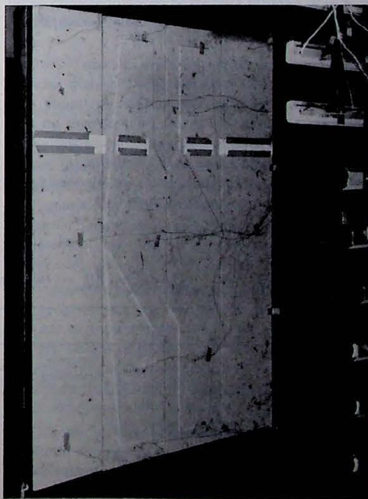
Fig. 21 — Panneaux de 300 × 60 cm destinés à la mosquée de Medina, préparés en vue de l'essai d'enseiement artificiel.
