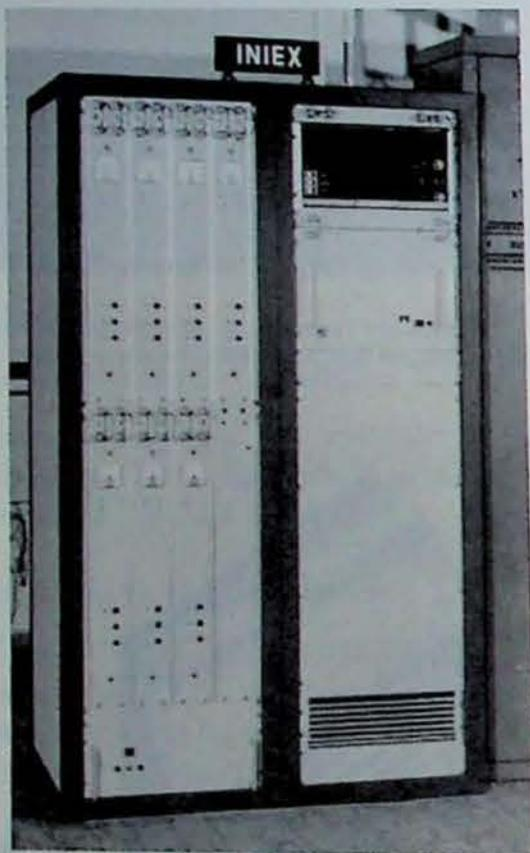
Fig. 14 — Des relais simplex originaux ont été conçus pour assurer les communications bilatérales dans les tunnels de l'avenue Louise, en fréquence modulée et en modulation d'amplitude (7 canaux simultanément en service).
