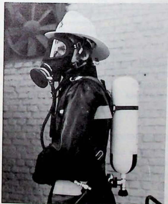
Fig. 29 — Autonoom toestel met overdruk en met open kring Auer BD 73/1800-3
