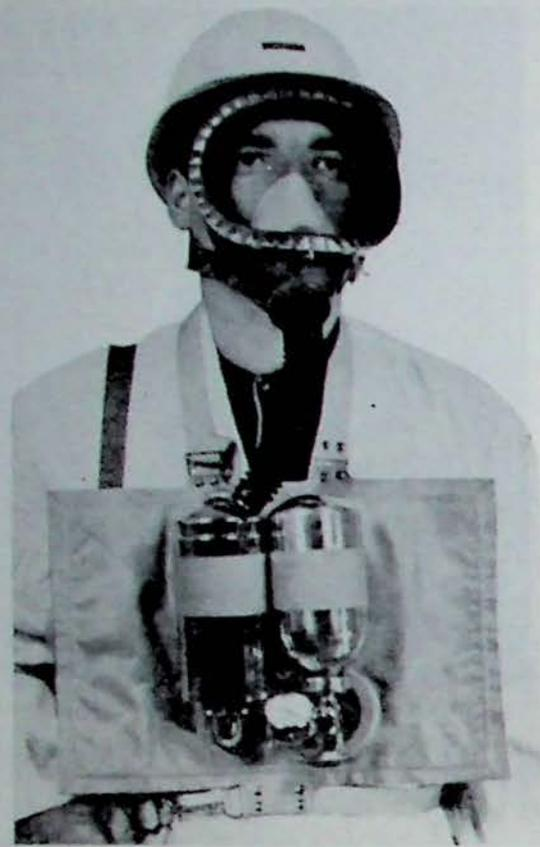
Fig. 31 — Appareil autonome à circuit fermé Fenzy 66
