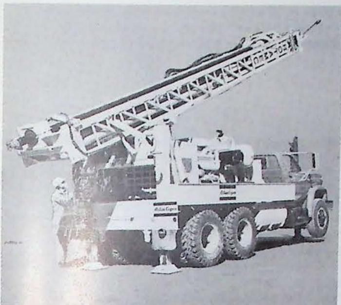
Fig. 9 — Sondeuse rotative Atlas Copco de type Rotamec 1300
