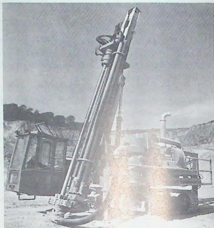
Fig. 8 — Nouvelle sondeuse Wirth de type S 2 R, entièrement mécanisée, avec cabine climatisée pour l'opérateur
