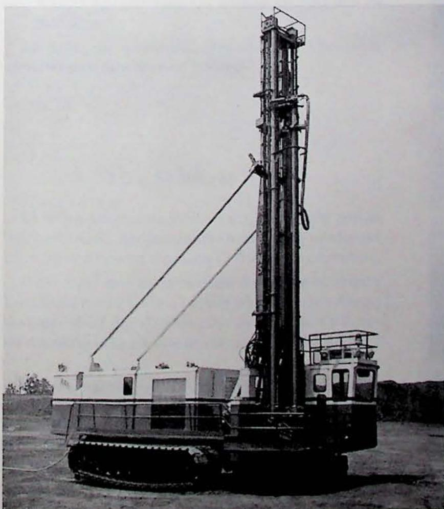
Fig. 5 — Sondeuse Joy-Robbins RR 11, équipée d'un mât très léger
