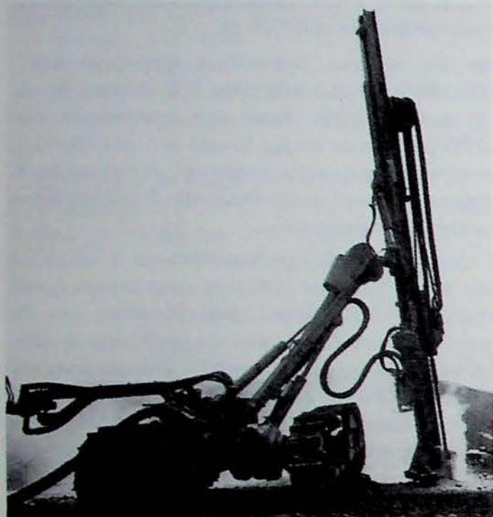
Fig. 18 — Foreuse percutante Demag à commande pneumatique de type CRD 45
