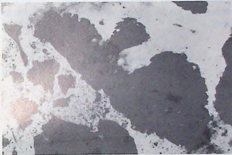
Fig. 6 — Les grains de quartz sont volontiers corrodés par l'hématite (en blanc) 130 ×.
