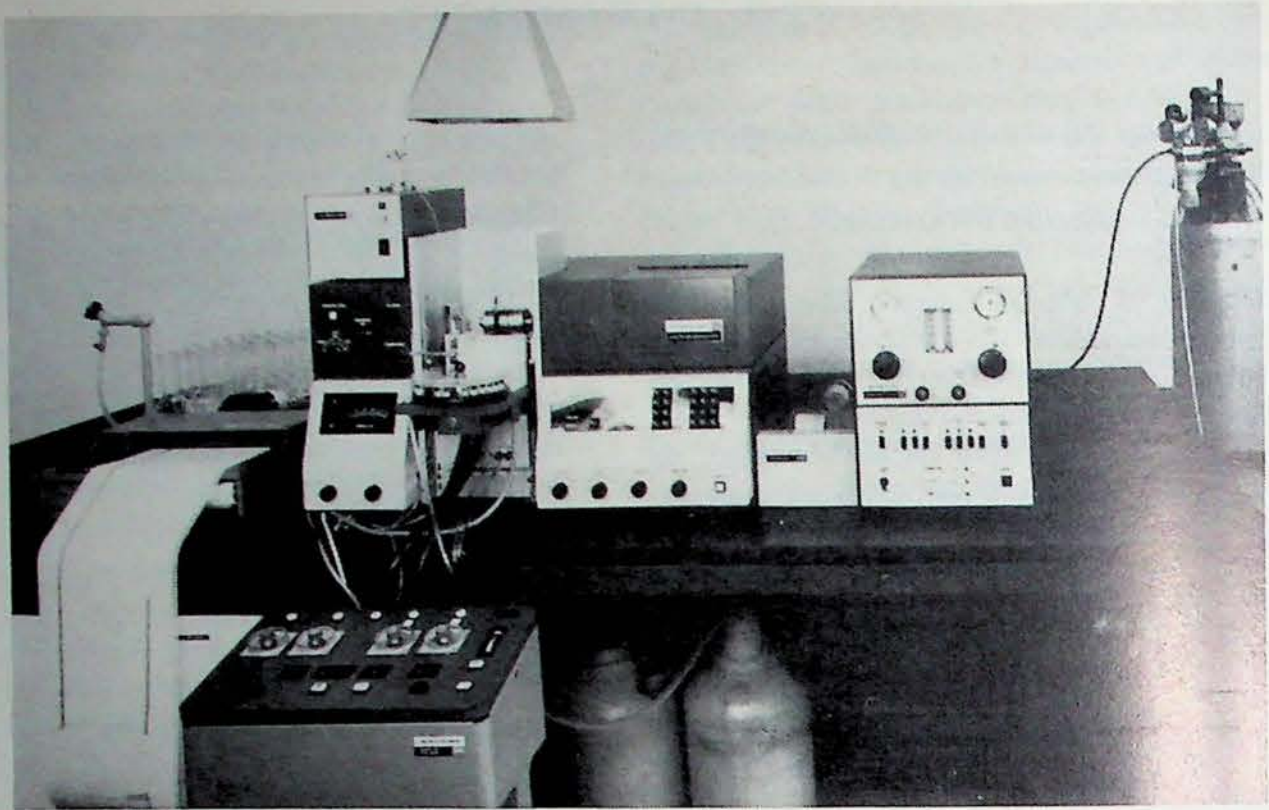
Fig. 7 : Spectrophotomètre Perkin-Elmer modèle 460 équipé de : — un microordinateur contrôlant la calibration des paramètres de lecture — un atomiseur à tube de graphite pour la recherche d'éléments à l'échelle du ppb — un échantillonneur automatique
