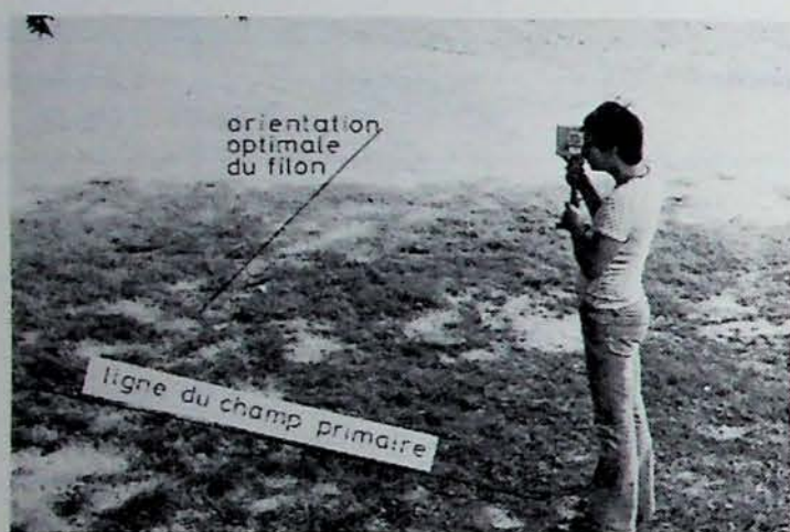
Fig. 14 — Manipulation du Géonics EM16 pour une lecture.
