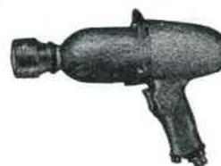
Boulonneuse pour cadres
