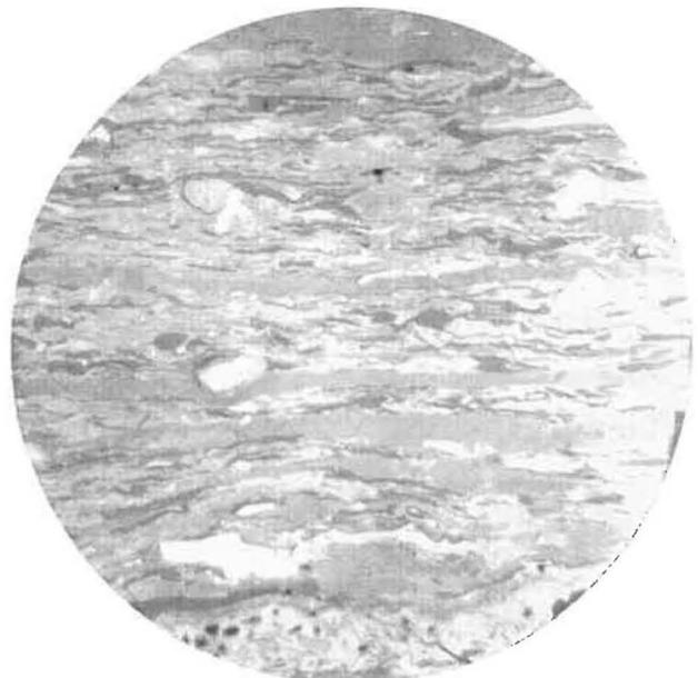
Fig. 3. — Surface polie d'un charbon de 27 % de matières volatiles (300 X, immersion d'huile).
