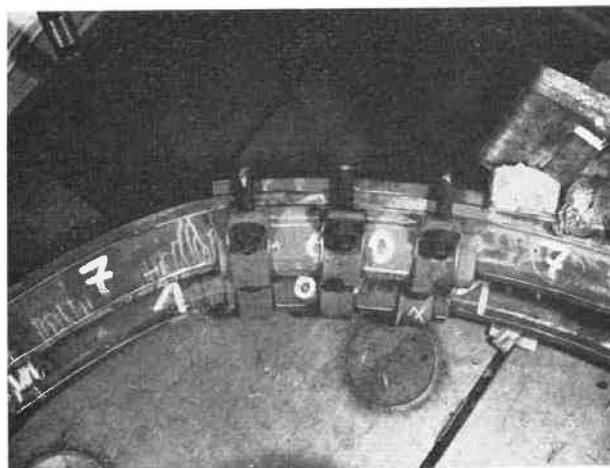
Fig. 53. — Détail du flambage des cadres ; on constate les variations du rayon de courbure près de l'assemblage.
