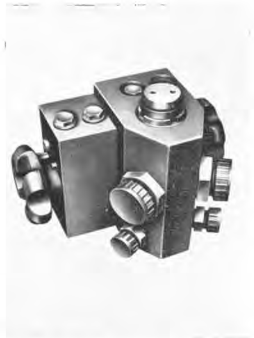
Fig. 4. — Bloc-vanne de commande avec robinet de ripage y accolé.
