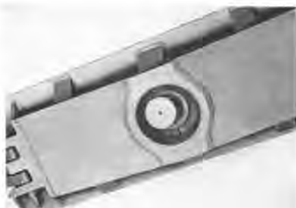
Fig. 14. — Tête d'étau prisonnière pour couche pentée.
