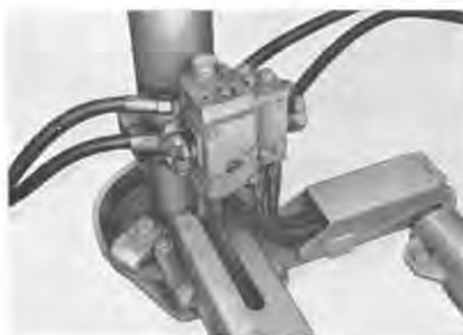
Fig. 12. — Rehausse de bloc-vanne.
