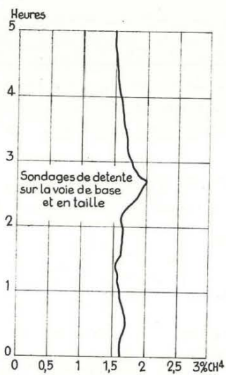
Fig. 18. — Influence des sondages de détente sur la teneur en grisou (enregistrement par analyseur Onera 80).
