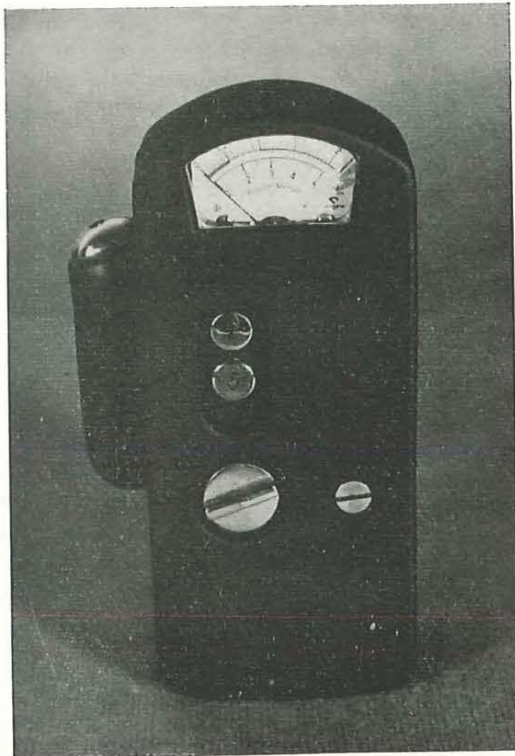
Fig. 3. — Grisoumètre portatif G 61.
