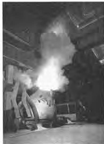
S.A. Cockerill-Ougrée - Usine d'Ougrée-Seraing. — Soufflage d'une cornue à l'aciérie Thomas.
