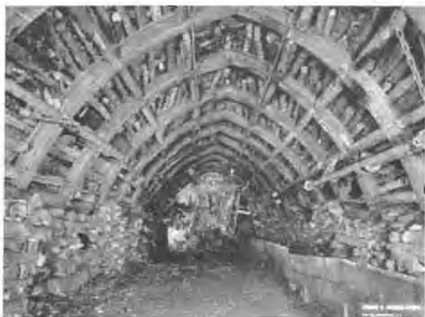
S.A. des Charbonnages du Gouffre - Siège n° 10. — Voie de taille en dressant - Soutènement articulé sur piles de bois. S.A. des Charbonnages du Gouffre - Siège n° 10. — Pijlergalerij in een steile laag - Gearticuleerde ondersteuning op houtstapels.
