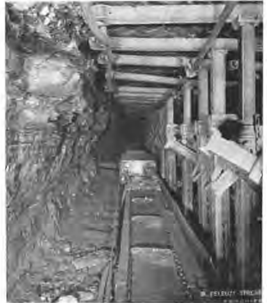
S.A. des Charbonnages de Monceau-Fontaine - Siège n° 6. — Abatage mécanique en taille - Haveuse sur convoyeur blindé.
