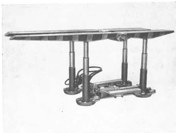
Fig. 10. — Élément 600/1200 avec bèles à articulation à peigne.
