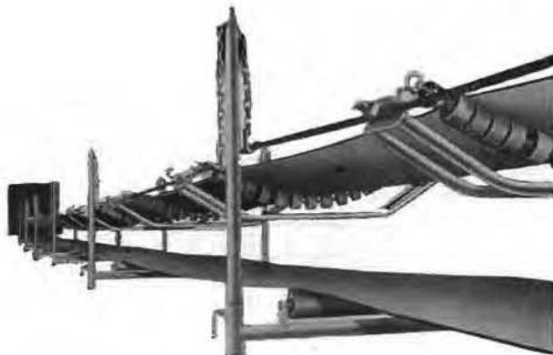
Fig. 15. — Le convoyeur Limberope à support par câble acier.
