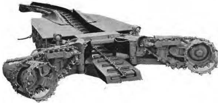
Fig. 3. — Le mineur continu Joy CU-42 Compton pour couches minces n'a qu'une hauteur de 760 mm. Ses têtes de havage circulaires montées sur bras articulés produisent une forte proportion de gaillettes.
