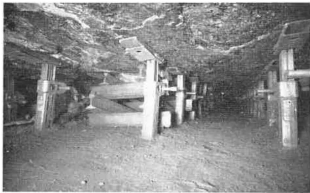
Fig. 15. — Siège n° 23. — Taille 4 Paumes levant à 1.220 m. Havée de passage du personnel avec une des 65 piles de rails équipant la havée. Toit assez médiocre.
