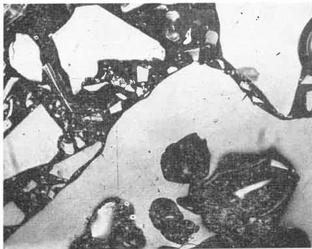
Fig. 4. — Début du ramollissement. Les gros grains montrent des pores, les petits grains n'en montrent pas.
