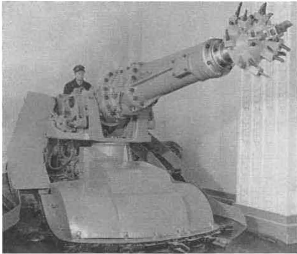
Fig. 21. — Machine russe PK3 pour la mécanisation du creusement des voies.
