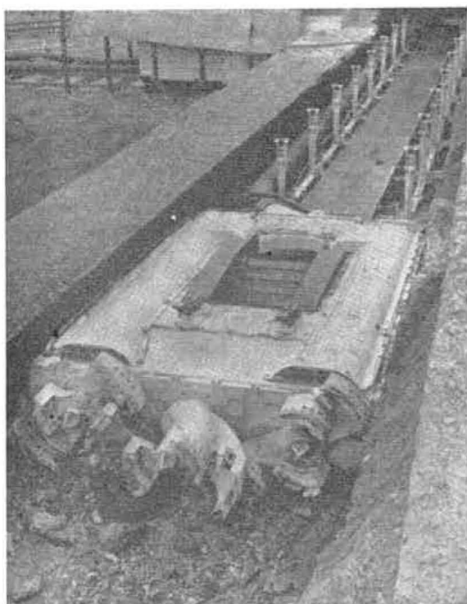
Fig. 17. — Abatteuse télécommandée Collins Miner.
