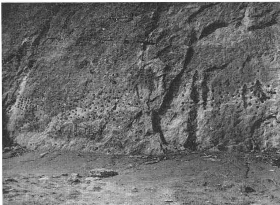
Fig. 4. — Vue d'ensemble des trous forés à la carrière de petit granit.
